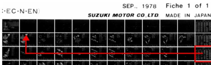
Kennt man die Teilenummer und fragt sich, welches Teil dies ist, nutzt man den „Part Number Index“ in der 16. Spalte. Hier findet man die Adresse (z.B. B5) und identifiziert dann das einzelne Bauteil in der Baugruppenzeichnung.
